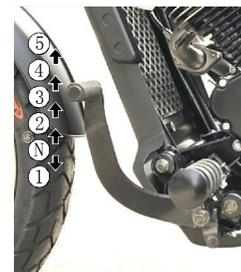
当变速器处于空档位置时，仪表上空档指示灯将被点亮，仍应慢慢松开离合器杆，以确定变速器是否确实处于空档位置。
