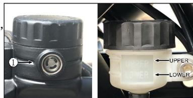
本车所使用的是DOT4号刹车油。不可使用油杯的余液及上次维修留下的液压油，因旧液会吸收空气中的水分。注意别把刹车液溅到油漆面或塑胶表面，它会侵蚀这些物质的表层。
