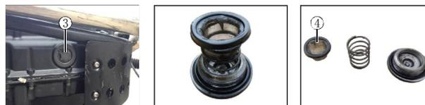
(4)、将清洗干净的机油滤网以及机油滤网弹簧、机油滤网盖装配完整。
