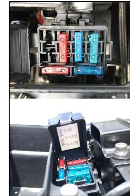
在检查或更换保险丝前，为避免出现短路以及其它电器元件，点火开关应置于“关（~~ON~~）”位置。
