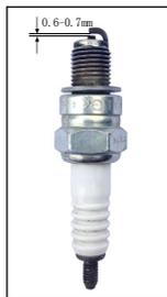
火花塞不要拧得过紧或使螺纹交错，以免损坏气缸盖的螺纹。拆下火花塞时，不要使杂质通过火花塞也进入发动机内。
