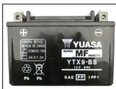
重新安装蓄电池时，务必将蓄电池的导线连接正确。如果将电池导线接反，将会导致电路系统及电池本身损坏。红线必须接于正极端(+)，黑线必须接于负极端(-)。检查或者更换电池时请务必关闭电源开关(钥匙)。
