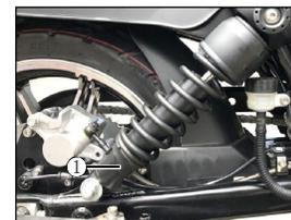
减震器弹簧另一端有调节支架①，用专用调节工具将调节支架①向左或向右旋转，改变对减震弹簧的预压，从而改变减震器硬与软的问题。左右两边减震器同时调整，并调到同样的位置。
