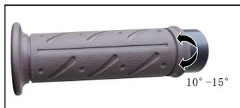
本车配置双线结构油门钢索，油门钢索①是加油门线，油门钢索②是回油门线。请按以下步骤调节油门握把自由行程：
