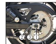
来调整链条的松弛度，在调整链条的同时也必须保持前后链轮对准中心成一直线。为有助于您进行这个调整过程，在摆动臂及每一链条调整器上均有基准标记，它们可以互相对准以及作为从一端到另一端的参照。对准及调整好链条的松弛度到10-20mm之后，要重新固定好后轴螺母，进行最后检查。
